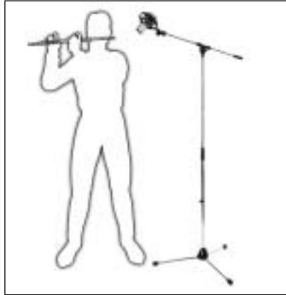
Fig. 8: Captar a flauta com um só microfone
